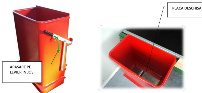
Figura 2. Deschiderea jgeaburilor de descarcare
